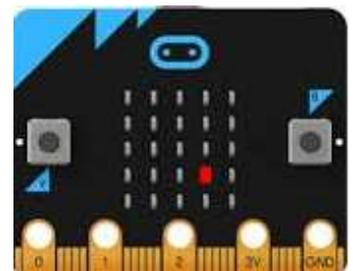
Im Hauptprogramm wird die Funktion `randomLed()` in einer Endlosschleife alle 200 Millisekunden aufgerufen. Das Programm läuft also so lange, bis du ein neues Programm hinunterlädst, den Resetknopf (Button neben dem USB-Anschluss) drückst oder die Stromversorgung unterbrichst.
