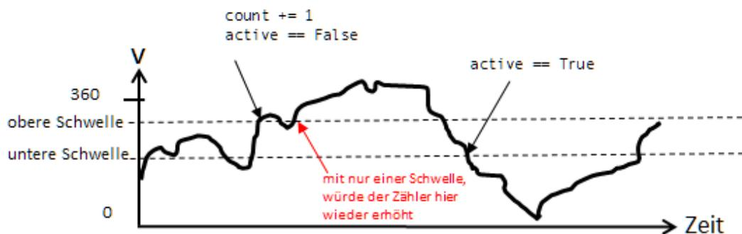
Zum Zählen der Umläufe genügt ein einziger Schwellenpegel nicht, sondern es müssen zwei Pegel definiert werden. Beim Überschreiten des oberen Pegels wird der Zähler erhöht und gleichzeitig aber das Zählen inaktiv gemacht. Erst beim Unterschreiten des unteren Pegels wird das Zählen wieder aktiviert.
