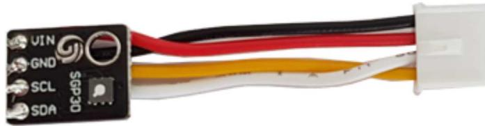
Am micro:bit wird der Sensor über einen I<sup>2</sup>C-Hub angeschlossen.
