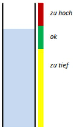
Am besten stellst du dir vor, dass sich das Gefäß in drei "Zuständen" befindet, die du mit der Variablen *state* erfasst, welche die Werte "high", "ok" und "low" annehmen kann. Aus dem skalierten Wert des Magnetfelds triffst du den Entscheid, ob sich der Zustand ändert.
