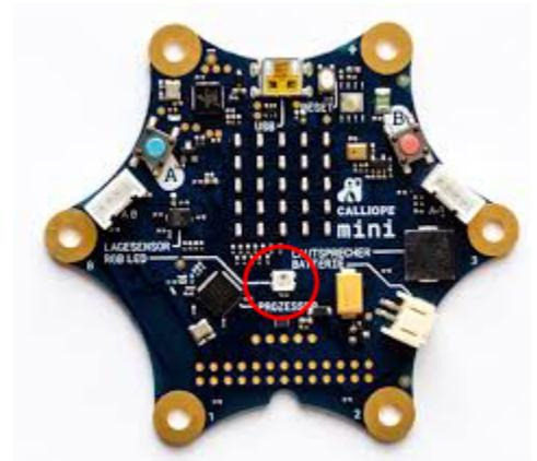
Der **Calliope\_mini 3** verfügt über drei RGB-LEDs. Diese werden als Neopixel angesprochen:
