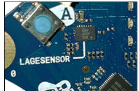
Es ist ähnlich wie bei der Lageanzeige von Flugzeugen, die mit einem künstlichen Horizont angezeigt werden. Wenn man das Board nach vorne oder nach hinten neigt, ändert der Pitch-Winkel, bei der Seitwärtsneigung ändert der Roll-Winkel.
