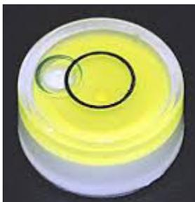
Der Calliope soll wie eine Wasserwaage-Libelle funktionieren. Dabei verwendest du die Tatsache, dass die x- und y-Komponenten der Beschleunigungen ungefähr 0 sind, wenn sich das Board in waagrechter Lage befindet.
