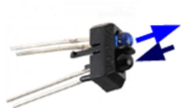
Durch diese Konstruktion können Infrarotsensoren die Änderungen im näheren Sichtfeld registrieren und werden in der Praxis häufig als Bewegungsmelder eingesetzt.
