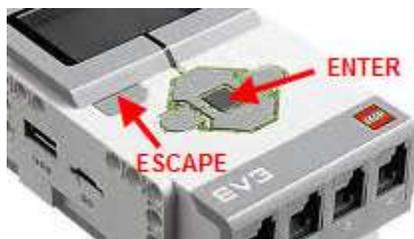
Für die Bedienung verwendest du die 4 Cursortasten, die zentrale ENTER-Taste und die ESCAPE-Taste oben links. Du kannst dich bereits ein bisschen daran gewöhnen. Zum Ausschalten drückst du beispielsweise zuerst ESCAPE, dann gehst du mit der Cursortaste RIGHT auf ✓ und bestätigst die Auswahl mit der ENTER-Taste.
