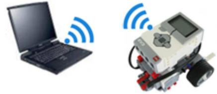
Um mit dem EV3 via WLAN zu kommunizieren, benötigst du einen USB-WLAN-Adapter. Wir empfehlen "**Edimax EW 7811UN**". Den Adapter musst du vor dem Einschalten des Roboters in den USB-Port des EV3 einstecken.
