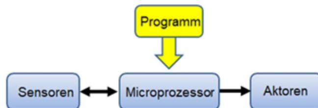
**Sensoren** sind Messgeräte, welche physikalischen Größen, wie Helligkeit, Distanz, Temperatur, Luftfeuchtigkeit usw. messen und an den Mikroprozessor weiterleiten.
