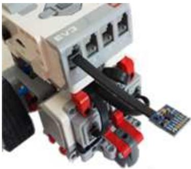
So präparierten Sensor kannst du danach z.B. am Sensorport 1 anschliessen.
